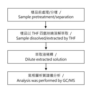
【測試方法/Test method: IEC 62321-8】
